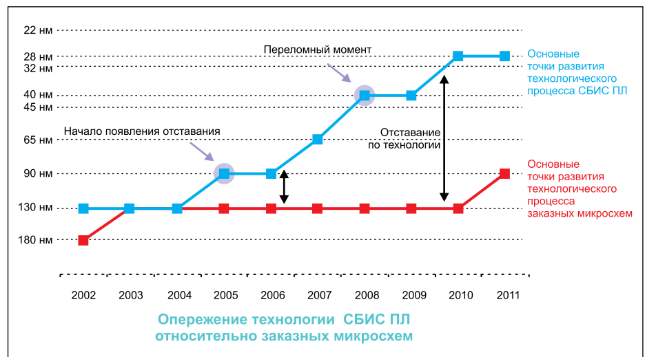
Рис. 3. Переломные моменты развития технологии СБИС ПЛ по сравнению с заказными микросхемами
